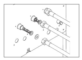
**Сетки** фильтров в клапанах для залива воды необходимо время от времени проверять и при их загрязнении очищать.
