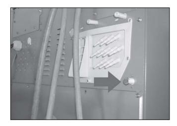
■ Открыть сливной клапан, для чего ослабить винт выпуска воздуха (размер ключа 17) на задней стороне машины, но не выворачивать его полностью. Оставить вытекать наружу моющий раствор.
