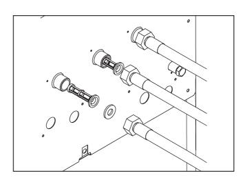
Прежде чем привернуть к машине заливные шланги, следует установить имеющиеся в прилагаемой упаковке сетки фильтров и уплотнители.
