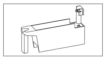
Вытащить сифон, промыть его теплой водой, после чего вставить на место.
