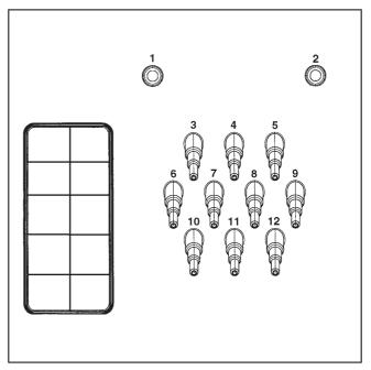
Подключения **1** и **2** предусмотрены для дозирования пастообразных средств. Эти патрубки для подключения закрыты и их следует просверлить сверлом диаметра 8 мм.
