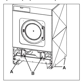
Удаляются боковые крепящие уголки "А" (по 2 справа и слева), закрепленные каждый одним винтом с шестигранной головкой. 2 передних и 2 задних крепящих уголка "В" закреплены каждый 3-мя винтами с шестигранной головкой и удаляются только на месте установки перед запуском стиральной машины.
