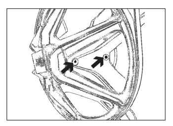
**Подшипник барабана** смазывается примерно через 1000 часов эксплуатации через специальные штуцеры маслом **Arcanol L 100**.
